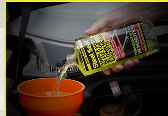
2. Encienda la calefacción y el ventilador al máximo. Arranque el motor y deje que el vehículo alcance la temperatura de trabajo. Despues déjelo en ralentí durante 30 minutos. Apague el vehículo y deje que se enfrie por completo. Añada anticongelante o agua según sea necesario y vuelva a colocar el tapón del radiador.
